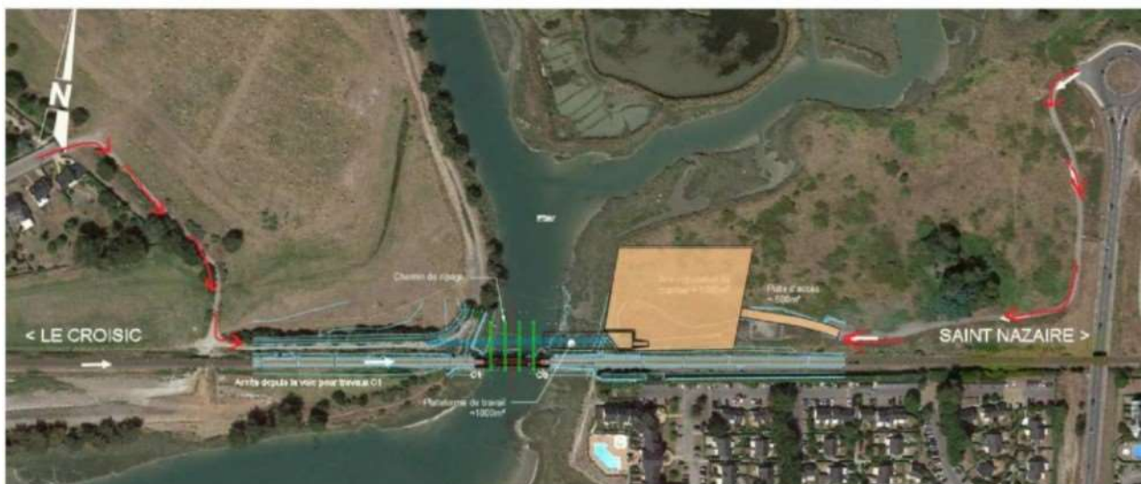
Figure 3: Plateforme de chantier et accès – source étude d'impact page 29
